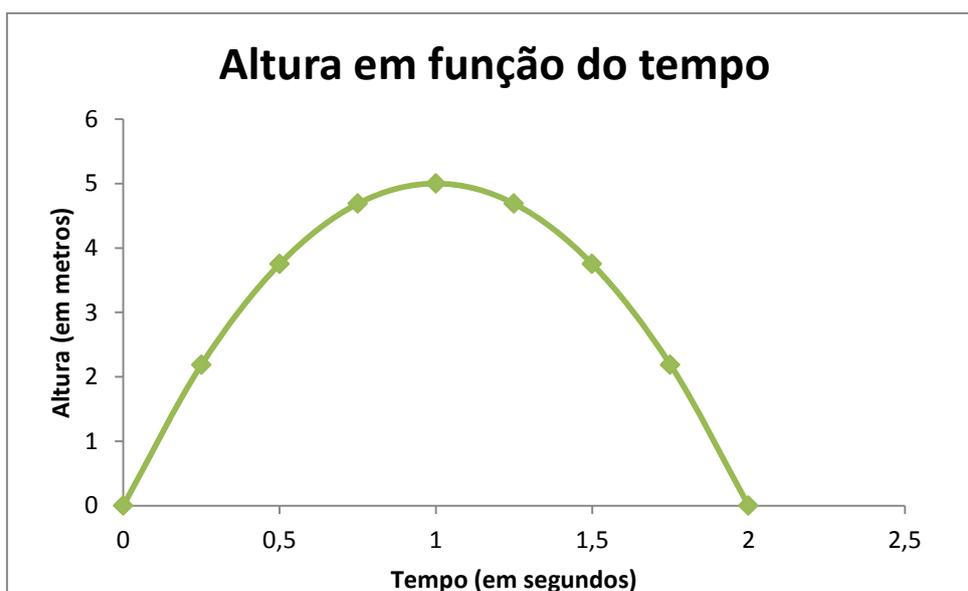
Figura 18: Gráfico da variação da posição em  $y$  em função do tempo. Como há movimento vertical sob influência da aceleração da gravidade, a altura varia até um ponto máximo e então passa a diminuir. Como deduzido matematicamente pela obtenção das equações de movimento anteriormente, o tempo para se chegar ao alcance máximo ( $y = 0$ ) é duas vezes o tempo para se chegar à altura máxima ( $v = 0$ ).
