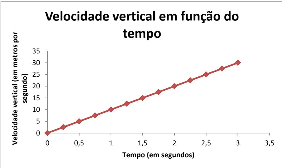
Figura 16: Variação da velocidade vertical em função do tempo. Como há ação da gravidade, ela aumenta em  $9,8m.s^{-2}$ .
