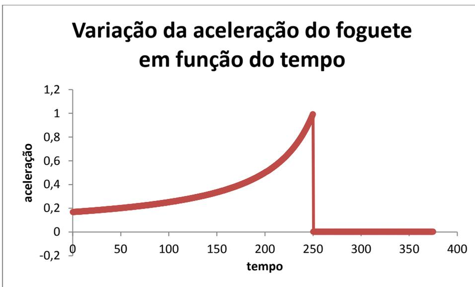
Figura 48: Este gráfico mostra o quanto a aceleração muda em função do tempo, utilizando  $m(x)$  linear. Conforme o tempo avança, a aceleração se torna cada vez maior, até o instante  $t = 250$ , em que a massa do foguete atingiu a da carcaça, ele para de acelerar e a velocidade fica contínua.
